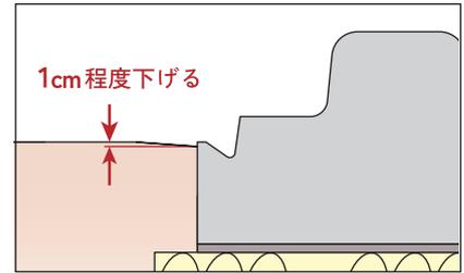
防草切り欠き部に土砂が入らないよう、路盤の高さを切欠き部より約1cm低くしてください。
