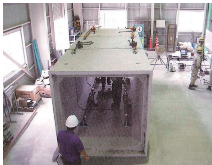
曲線施工試験 (IB50 タイプ)
