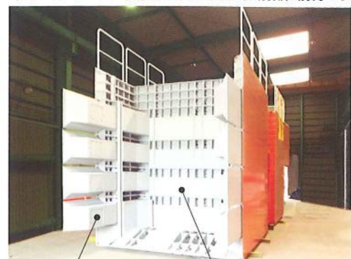
スライド式土留 隔壁
