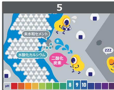
細菌は炭酸カルシウムの他に、少量の水と二酸化炭素を排出します。これらはコンクリート内に残っている未水和のセメントを炭酸カルシウムに変え、小さな穴や細かなひび割れも埋めていきます。
