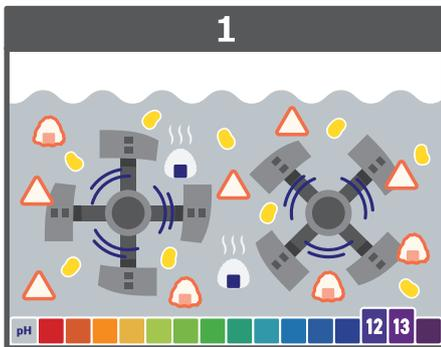
ミキサーでの練り混ぜにより、細菌とポリ乳酸はコンクリート全体に分散されます。その後ポリ乳酸は、生コンクリート中の水やアルカリ成分によって徐々に分解され、細菌の餌となる乳酸カルシウムに変わっていきます。
