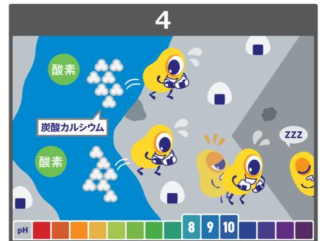
目覚めた細菌は分裂を繰り返し、餌となる乳酸カルシウムを摂取して炭酸カルシウムを排出し、ひび割れを埋めていきます。
