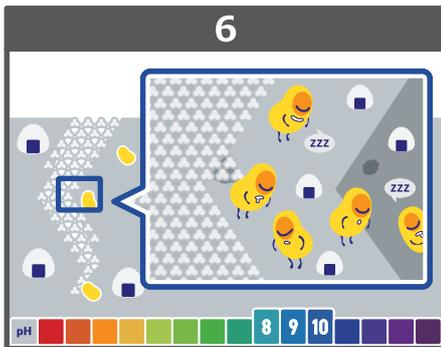
細菌が排出した炭酸カルシウムでひび割れが完全に埋まると、水や酸素が完全に遮断され、細菌は再び休眠状態となり次のひび割れ発生に備えます。
