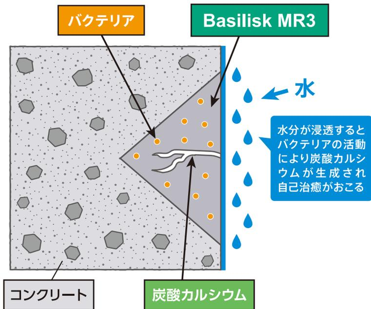
◆細菌と栄養分が含まれており、水と接触することで細菌が活動し、炭酸カルシウムを生成します。生成した炭酸カルシウムは、補修材自身のマイクロクラックや構造物と補修材の境界面を炭酸カルシウムで埋めるため、補修材自身の自己治癒効果や止水性能の回復、凍害に対する耐久性向上の効果を持ちます。
